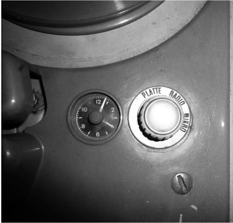
Zählwerk und Eingangswahlschalter an Scelsis Tonbandgerät
